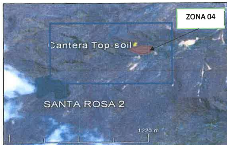
Imagen 14. Ubicación de MATERIAL TOPSOIL DENTRO DE PROYECTO, CONTAMINADO CON MATERIAL DE DESMONTE.
