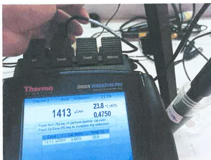
Estado del electrodo de conductividad Modelo: 087010MD, Serie: YT1-120091
