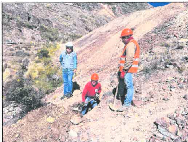
Imagen 12. Cantera dentro del proyecto Zona 4, presencia de capa de Topsoil, 0.4 aprox. contaminado con material de desmorte y otros estratos inadecuados.
