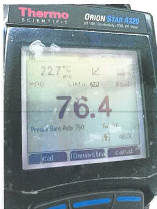
Medición de OD en una muestra de agua destilada.
